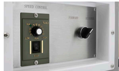
Controllo velocità degli alberi riavvolgitori posteriori
