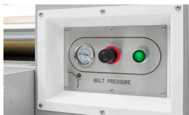
Rullo pressione per tenere a contatto il tappeto con il rullo ad olio
